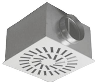
I diffusori a flusso elicoidale WT 100 sono dotati di deflettori regolabili disposti radialmente che permettono di ottenere due tipi di getti d'aria: vorticoso sulla circonferenza interna o esterna oppure verticale. L'intenso moto vorticoso consente di realizzare un'elevata induzione con lanci ridotti, garantendo un basso gradiente di temperatura nella zona occupata.
