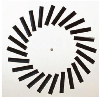
I diffusori a flusso elicoidale WX100 sono dotati di deflettori regolabili disposti radialmente che permettono di ottenere due tipi di getti d'aria: vorticoso sulla circonferenza interna o esterna oppure verticale. L'intenso moto vorticoso consente di realizzare un'elevata induzione con lanci ridotti, garantendo un basso gradiente di temperatura nella zona occupata.
